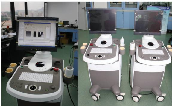
图10 自主研发的基于瞬时弹性成像技术的超声肝硬化检测仪
