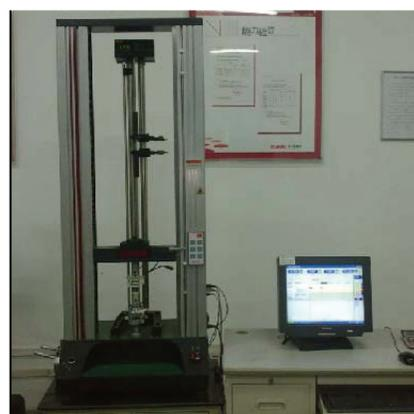
图7 压痕测试系统
