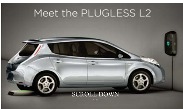
图 8 针对 Chevy Volt 和 Nissan Leaf 的 Plugless Level 2 电动汽车无线充电系统
