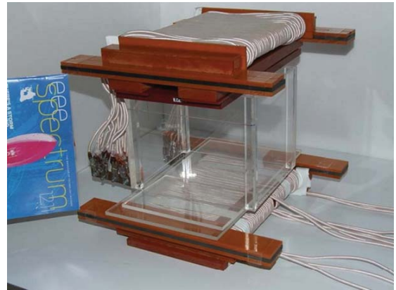
图 6 埼玉大学开发的 H 型耦合机构
