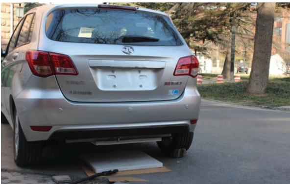
图 10 电工所在北汽电动车上开展无线充电系统装车示范
