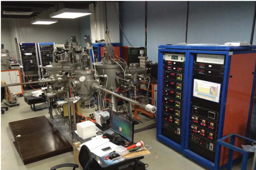
图 4 中国科学院深圳先进技术研究院自主研发的“四室八源共蒸发系统”
