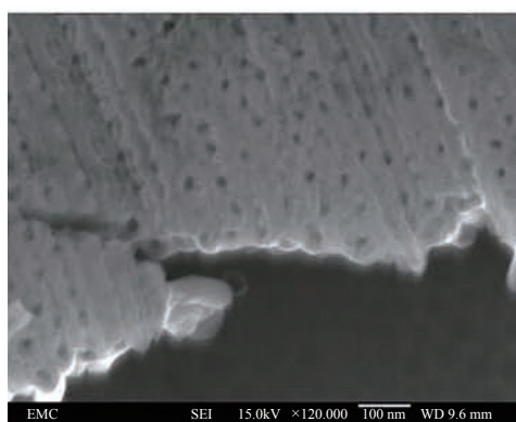
(b) 一步法中 HPT 样品上 TNT 的 SEM 正面照片
