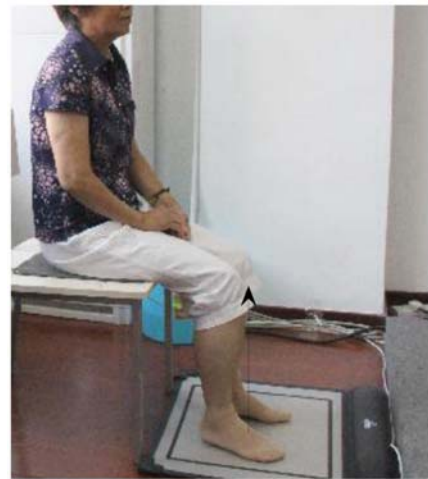
图4 MatScan@ 平板测试系统获取老年人在坐-起过程中的足底压力数据
