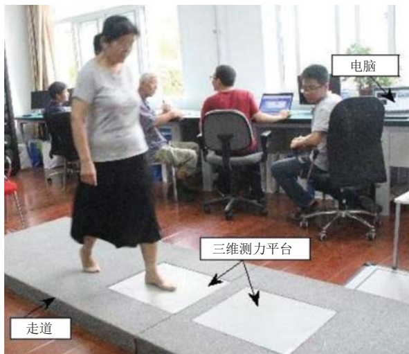
图 2 三维测力台实验示意图
