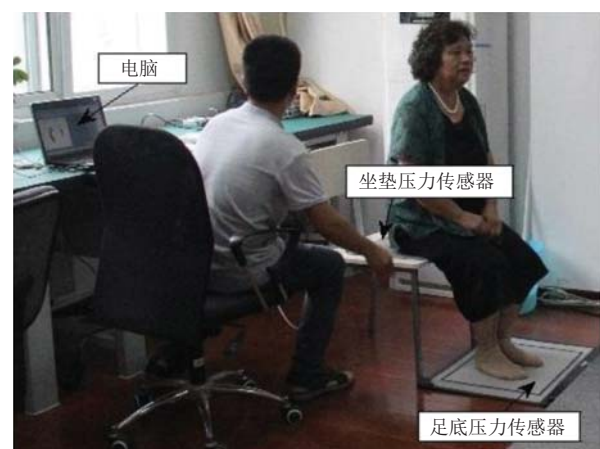
图 1 双压力传感器实验示意图
