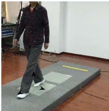
图3 OR6-7 三维测力台获取老年人行走时步态的运动学参数
