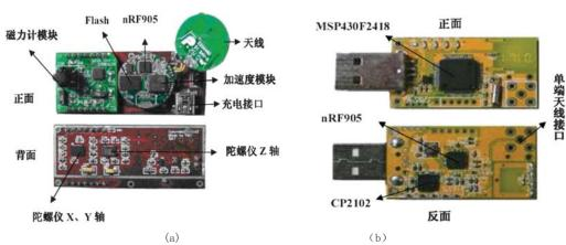
图1 (a)人体传感网络节点,用于采集人体运动九自由度信号(b)人体传感网络一基站,负责节点与pc等终端的通信
