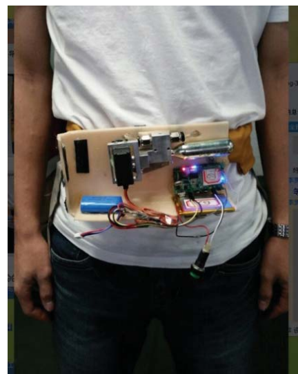
图 11 实验者佩戴跌倒预警与防护腰带
