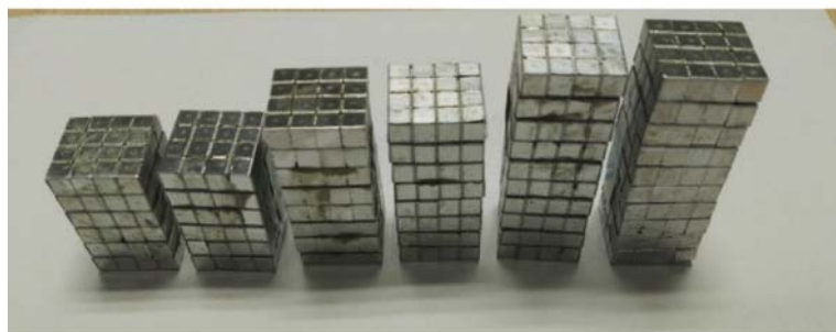
图 6 动态冲击压溃实验样件
