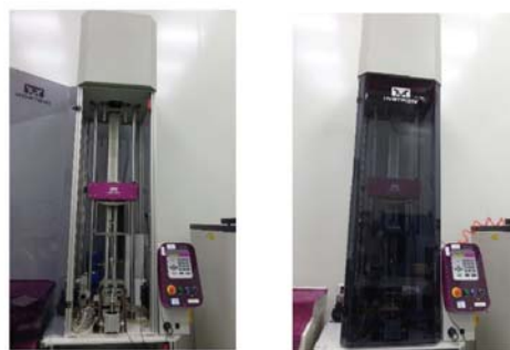
图 7 落锤式冲击试验
