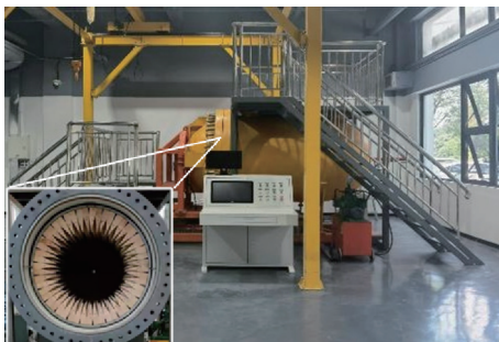
图 2 20 MPa 高压消声舱
