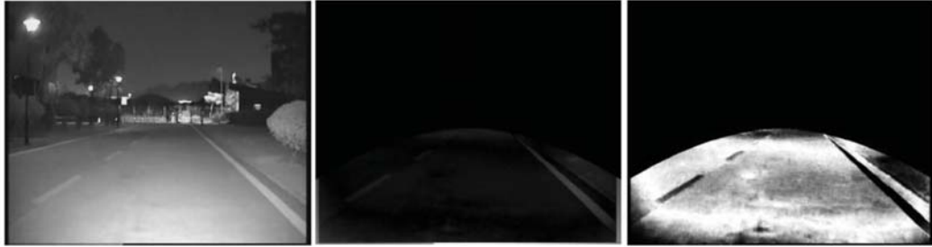
图3 (a) 原图片 (b) 与模型的绝对差图片 (c) 概率图片
