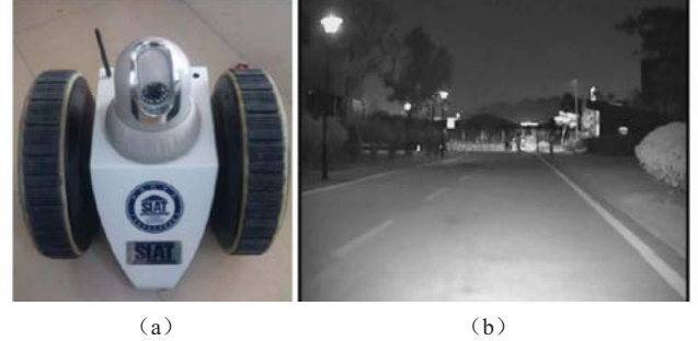
图1 (a) 移动机器人 (b) 采集到的近红外图片
