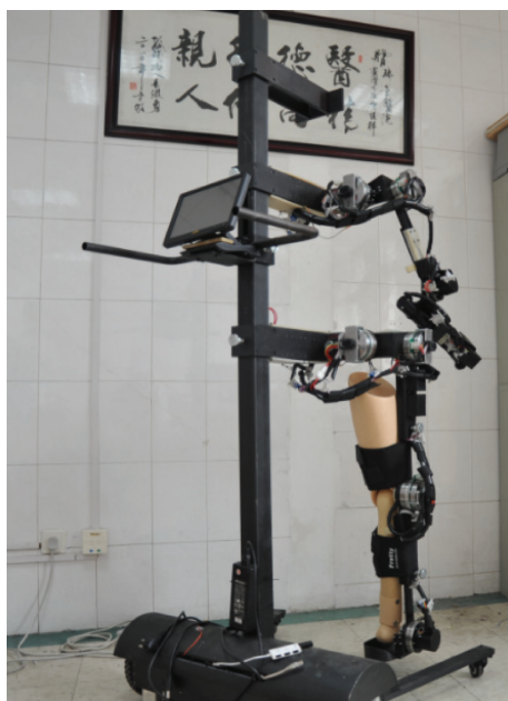
图1 一个可穿戴便携式康复外骨骼机器人
