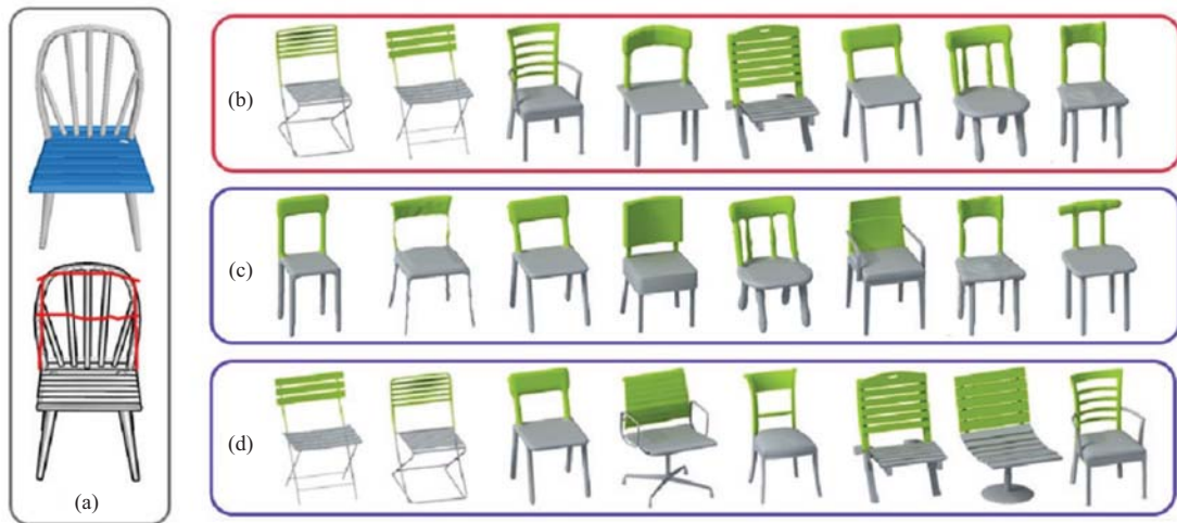
图 10 基于手绘草图的三维部件检索结果 [28] : (a) 表明目标模型中椅子坐垫已经被固定, 要根据用户的手绘草图检索椅子靠背; (b) 志愿者投票得分最高的 8 个候选部件; (c) 没有考虑上下文信息的检索结果; (d) 考虑了“sketch2design”系统中两种上下文约束得到的检索结果
