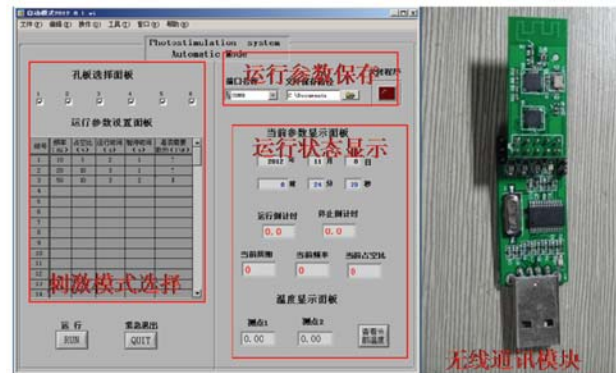
图 2 上位机软件界面和无线通讯模块
