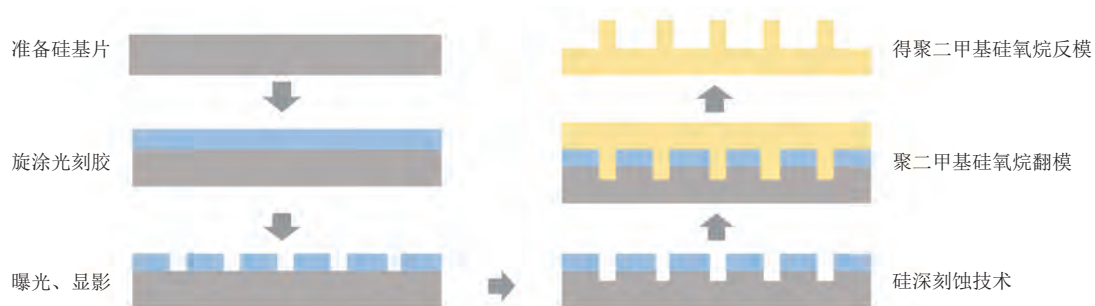
图 2 聚二甲基硅氧烷反模制备过程
