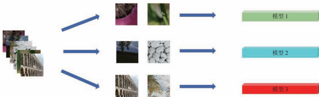
图 4 根据图像块的纹理特征将它们送入不同的模块
