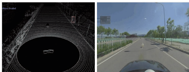
图 5 激光雷达对抗样本(障碍物)的检测失效 [14]
