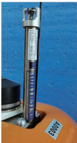
图 3 低功耗海上仪器回收通信信标
