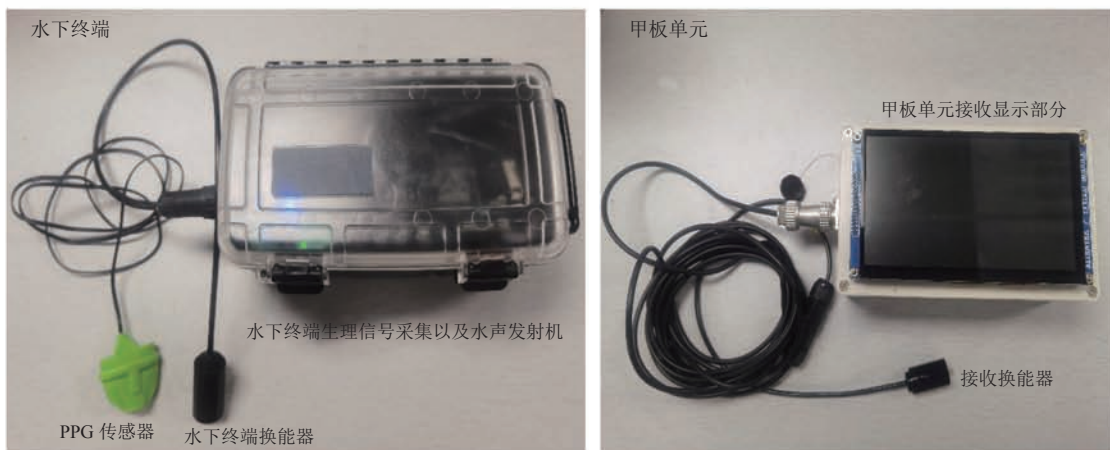
图 12 水下作业安全生理信号实时监测设备原型样机
