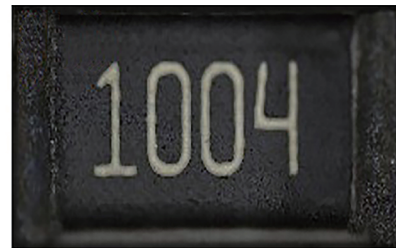
(b) 老化试验后失效电阻
