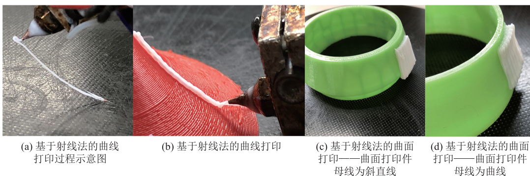
图 16 基于射线法打印曲面零件
