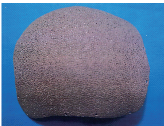
图 3 3D 打印钛合金个性化颅骨修复体
