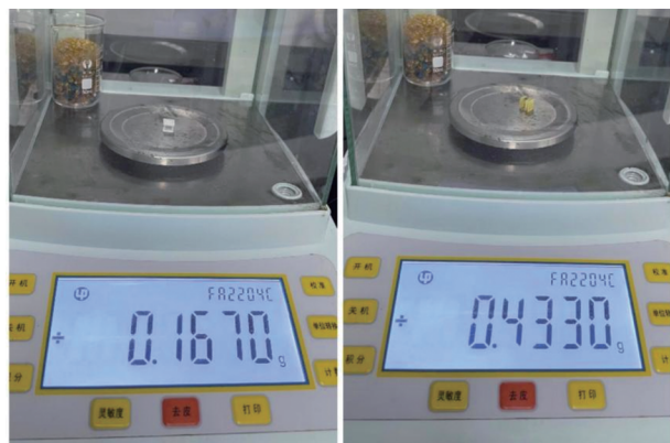
(a) 9400 树脂材料的电极支架质量称重 (b) PCB 板铜柱等组装的电极支架质量称重
