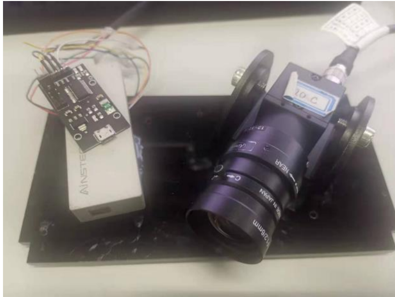
图 3、搭建的基于 MEMS 振镜的结构光三维扫描系统
