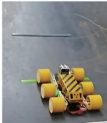
(a) 机器人前轮翻越高度 3.5 mm 的焊缝
