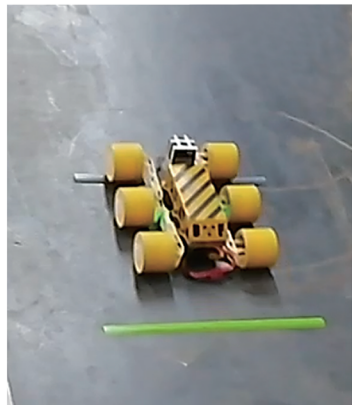
(d) 机器人前轮翻越高度 5.5 mm 的焊缝
