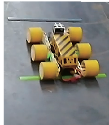
(c) 机器人后轮翻越高度 3.5 mm 的焊缝
