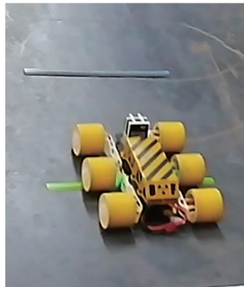
(b) 机器人中间轮翻越高度 3.5 mm 的焊缝
