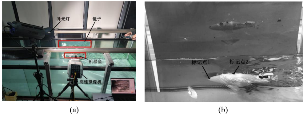
图 4 实验平台实拍图 (a) 和追踪机器鱼运动的标记点 (b)
